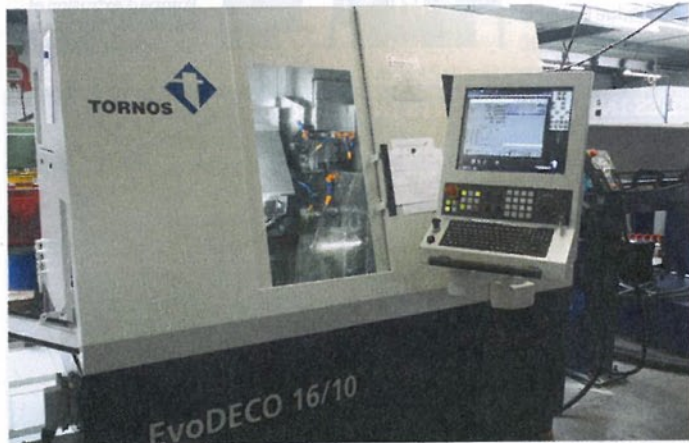
CN de 10 axes en \emptyset 16 avec sorties pièces longues.
